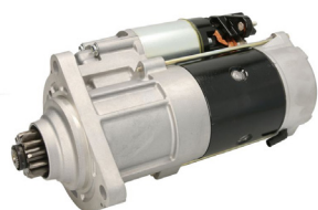
Mitsubishi startti Scania PGRT D16/DC16 Tuotenumero: CST35635GS Jännite: 24 V Teho: 7 kW Hammasluku: 11 Vertailunumero: 2777872, M9T83771
