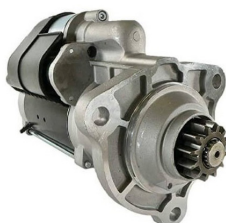
SEG Automotive startti Scania PGRT DC9-13 Tuotenumero: CST10682GS Jännite: 24 V Teho: 5,5 kW Hammasluku: 11 Vertailunumero: 2708317, 0001261028
