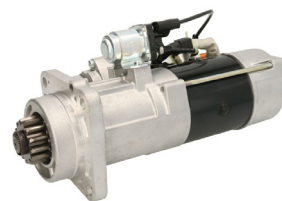
Mitsubishi startti MB Atego/Axor 2004→ Tuotekoodi: CST35633GS Jännite: 24 V Teho: 5,5 kW Hammasluku: 13 Vertailunumero: A0071514901, M9T64371
