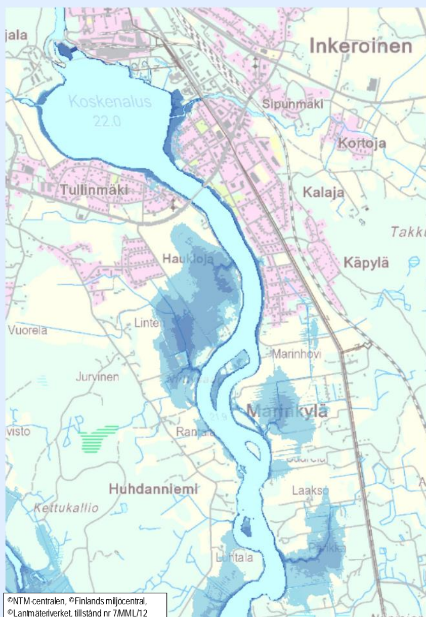
Bild 10.5. Översvämmat område vid Inkeroinen vid en översvämning på HW 1/250 (motsvarar en vinteröversvämning på HW 1/100 där höjningen till följd av kravis är 40 cm).
