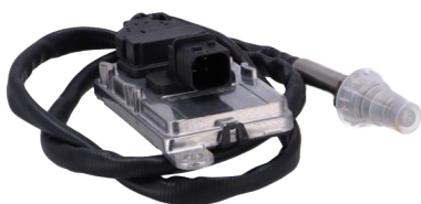
Scania PGRT/FKN ennen katalysaattoria v2.8
