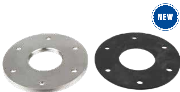
Adapter N3/N3H/S3/S3H från VDO tubulargivare Ø 55 mm Adapter för att ersätta en VDO tubulargivare Ø 55 mm med en Wema N3/N3H/S3. Invändig 1 1/4" gänga. Ytterdiameter 100 mm. 6xM6 bulthål. Tjocklek 6 mm. Packning ingår.
