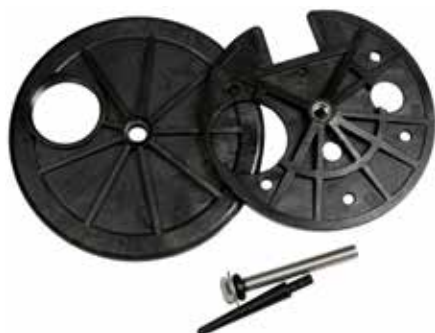
Inspektionslucka med R 1 1/4" Inspektionslucka med hål för Wemas N3/N3H/S3/S3H. Håltagningsmått i tank 115 mm. Ytterdiameter 150 mm.
