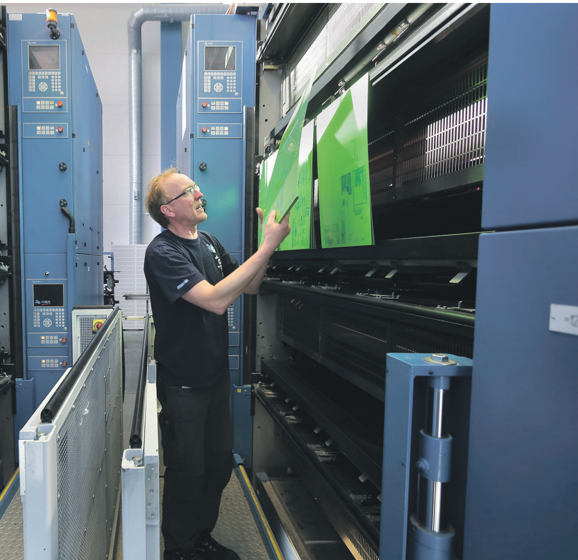
Ovanlig tryckpress. Tryckaren Pertti Salonen byter tryckplåtar i karlebytryckeriet Botnia Print, ett tryckeri som inte använder vatten i tryckprocessen.
