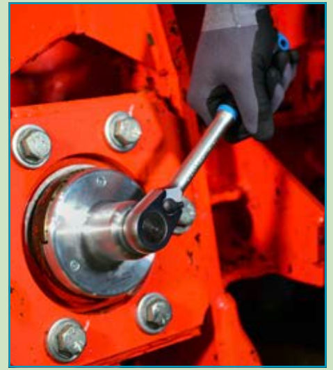
Käyttö räikällä ja ½":n (12,5 mm) nelikulmio- kiinnitysosan avulla
