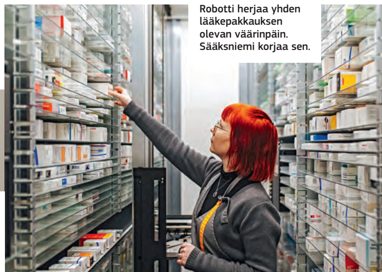
Lääkkeet syötetään robottiin yksitellen. Kerrallaan robotti ottaa vastaan 40 lääkepakkausta.
