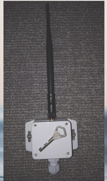
Kuva 3 (©Jari Silander): IoT -auto-maattiasema, jonka patterin kesto on vuosia sekä tiedon siirtokustannukset vain euroja vuodessa.
