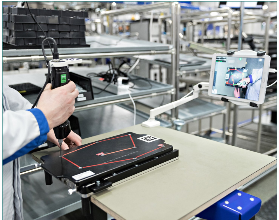
Telia ja Nokia kokeilivat 5G:tä yhdessä pilvilaskennan ja video-analytiikan kanssa Oulun tukiasematehtaan kokoonpanolinjalla. Kokeilu osoitti 5G:n mahdollisuudet vaativiin Industry 4.0 tyyppisiin käyttötapauksiin. Kuvassa video-analytiikka seuraa 5G:n yli, että asennus menee määritetyllä tavalla.
